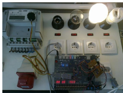
Sl. 4 Realizovan sistem za izračunavanje snage izobličenja
